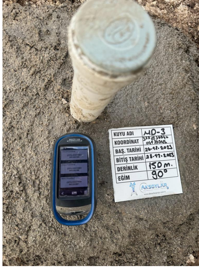
Şekil 66 Kuyu başı betonu, levhası ve etiketlemeleri.
