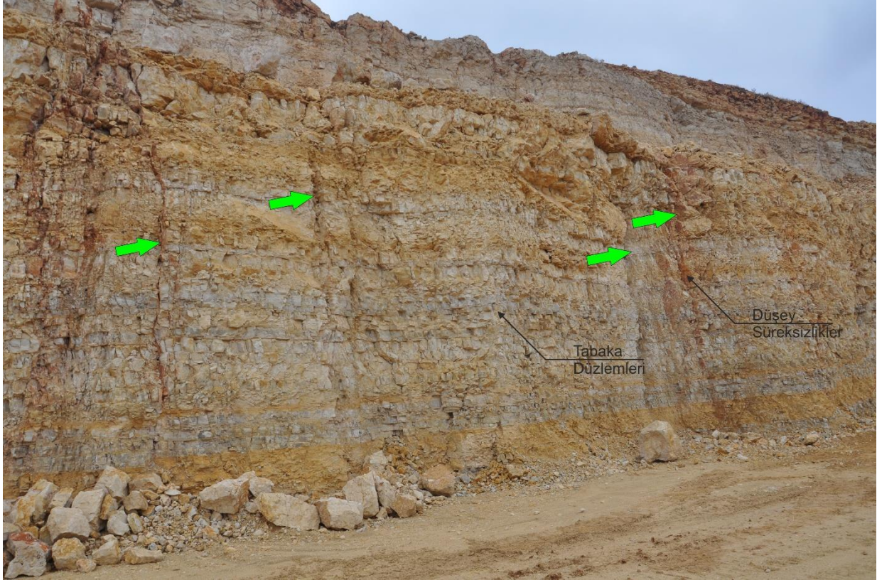
Şekil 83 Ruhsat sahası içerisinde gözlenen kireçtaşı mostralarında süreksizlik ölçümleri (GN- 2)0
