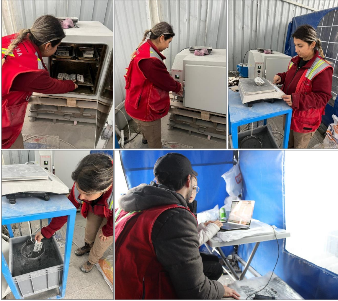
Şekil 64 Yoğunluk örneklerinin hazırlanması.
