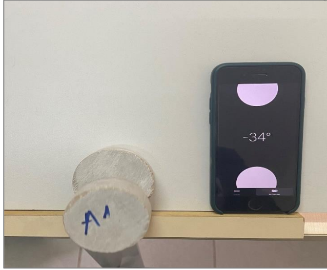
Şekil 93 Tilt deney düzeneği ve uygulamasından genel bir görünüm.
