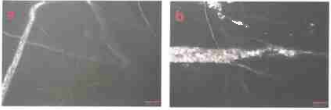
Şekil 5. 17502 nolu örneğine ait ince kesit fotoğrafları. Mikritik kalsit kristallerinin oluşturduğu karbonat çamuru matı iksi kesen iri kalsit kristallerinin doldurduğu kırıkların görünüşleri (a ve b)
