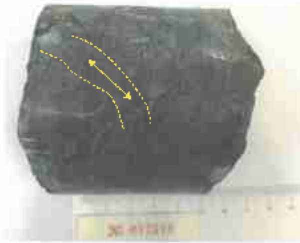
Şekil 28. 17519 nolu örnekte kataklamaya yol açan sıvıların oluşturduğu kanal
