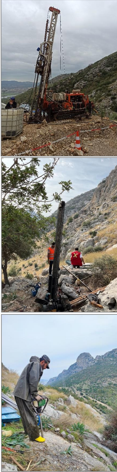
Şekil 63 Üstten döner sondaj makinası, ekipman ve malzemeleri (a: Tij, b: Karotiyer, c: çamur pompası, d: çamur karıştırıcı, e: karot sandıkları, f: bentonit)
